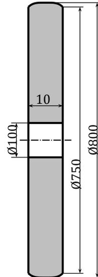
Bekanntlich muss eine Riemenscheibe für Flachriemen am Außendurchmesser eine ballige Kontur aufweisen, damit der Riemen nicht abspringt. Der Durchmesser am Rand dieser Kontur beträgt 750mm. Die Kontur wird durch folgende Funktion beschrieben:
