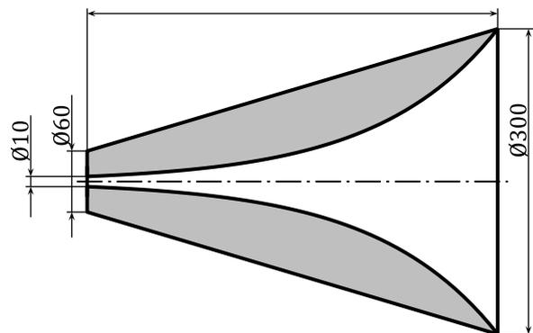
Der Trichter beginnt links mit einem Innendurchmesser von 10mm und endet rechts mit gleichem Innen- und Außendurchmesser.
