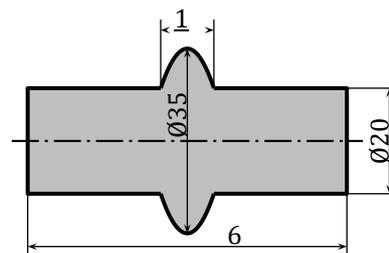
Das Drehteil soll aus Drehstahl S235JR mit der Dichte  $\rho = 7,85 \text{ g/cm}^3$  gefertigt werden. Welche Masse hat das Drehteil?
